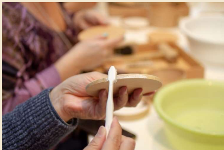
部材に接着剤を塗る
