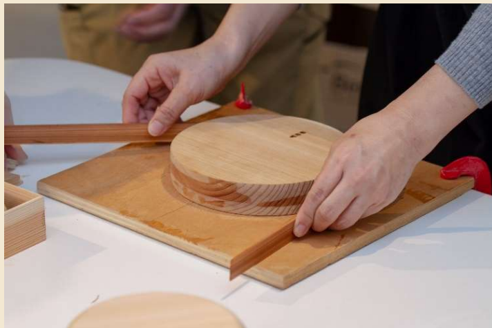
約80℃に浸けた部材を、型に合わせて曲げる
