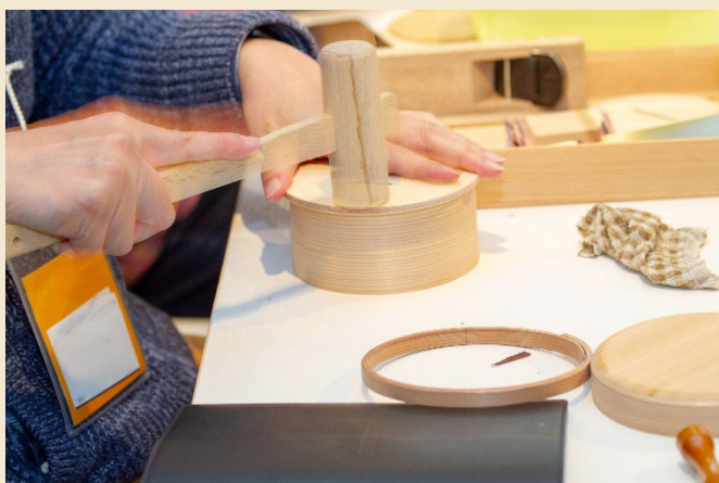
④木目を確認、木槌でたたきながら底板をはめる
