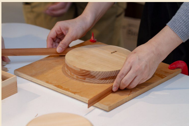
①約80℃に浸けた部材を、型に合わせて曲げる
