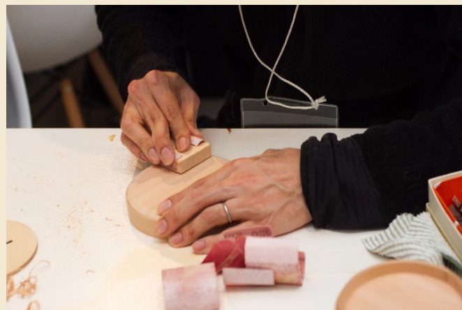
⑤数種類の紙やすりを使い、表面を滑らかに仕上げる
